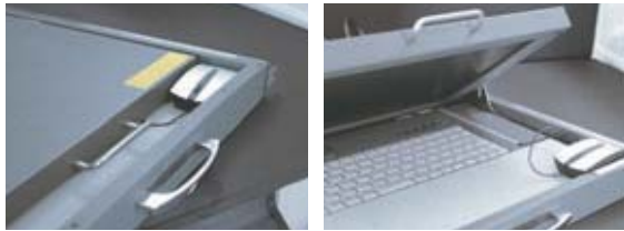
液晶モニターを持ち上げることで、キーボードが同時にリフトアップします。
