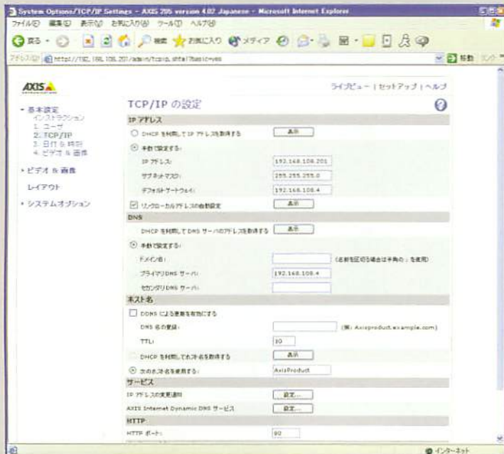
IPアドレス関係の設定画面。DHCPでIPアドレスを自動割当にしたり、IPアドレスが変更されたときにメールで通知するという機能も持つ。アクシスの提供するDDNSも利用可能になる予定だ
