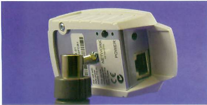
ACコネクタとLANコネクタは底面。LANコネクタは固定されるからいいが、ACコネクタの方が抜けてしまわないかちょっと不安だ。背面には電源とLANのインジケータ、そしてリセットなどに利用する操作スイッチを備える
